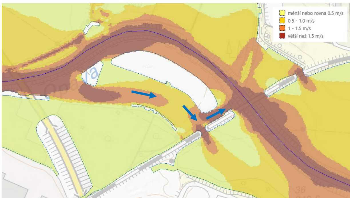
Obr. 6 Mapa rychlostí pro Q_{100} , MR 2019 – inundační most na pravém břehu nekapacitní a dochází k převádění vody do hlavního koryta mezi ostrovem a náspehem železničního tělesa
